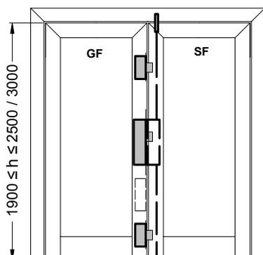
**Variante 17: Gangflügel: Motorschloss Mehrfachverriegelung
