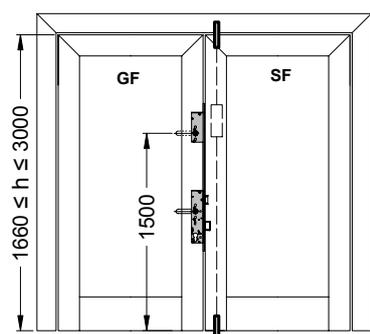
**Variante 6: Gangflügel: Antipanikschloss für Gangflügel
