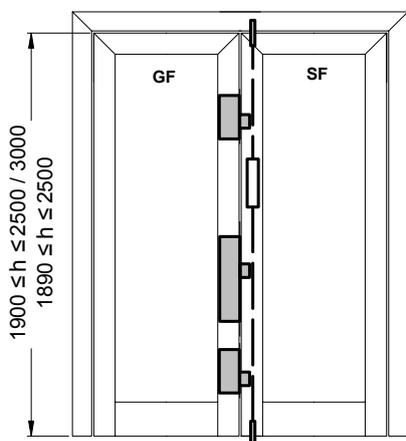
**Variante 13: Gangflügel: 3 Fallenriegelschloss Mehrfachverriegelung
