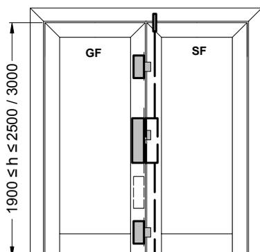
**Variante 15: Gangflügel: 3 Fallenriegelschloss Mehrfachverriegelung
