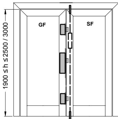
**Variante 16: Gangflügel: Riegel-Fallenschloss Mehrfachverriegelung
