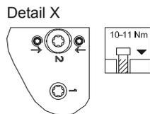
3. Befestigungsschrauben an allen Rahmenteilnahmen Pos. 1 wieder festziehen (10–11Nm)
