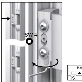
1. Unteren Gewindestift des oberen Bandes lösen.
