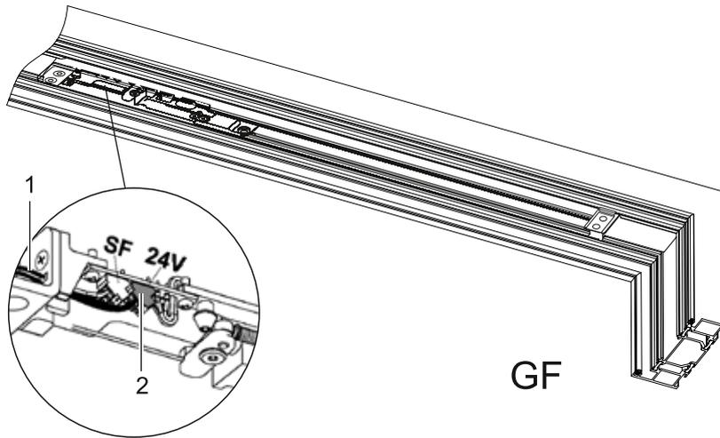
**Gleitschiene am Gangflügel montieren**
