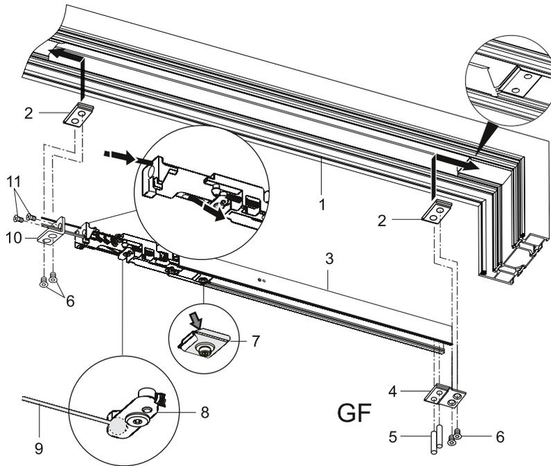
**Gleitschiene am Gangflügel montieren**
