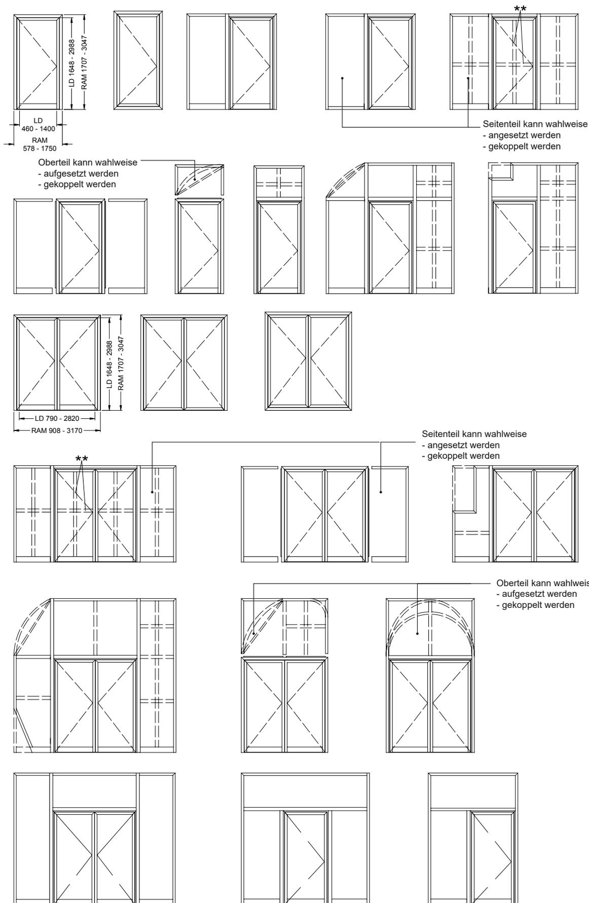
\*\* Wahlweise mit 1-2 vertikalen und /oder 1-5 horizontalen, glasteilenden Sprossen
