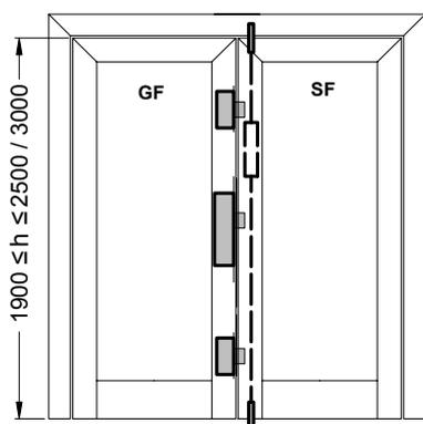
**Variante 14: Gangflügel: Riegel-Fallenschloss Mehrfachverriegelung
