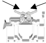
2. Klemmhebel direkt unterhalb des unteren Bandes einsetzen
