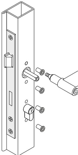
1. Die Einnietmuttern nacheinander auf den Gewindedorn eines Nietwerkzeuges aufschrauben.
