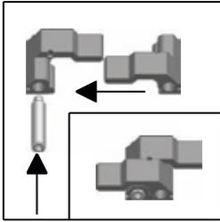
1. Einzelteile Verstellset zusammenfügen und Gewindesttift bündig eindrehen
