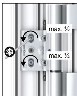
1. An allen Bändern Schrauben max. 1/2 Umdrehung lösen
