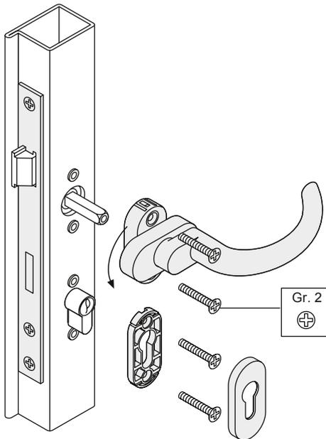
4. Der Rahmentürdrücker wird je nach Ausführung auf die Einnietmuttern gesteckt und mit den Senkschrauben befestigt. Dabei kann die Rutsch- und Schraubensicherung an der Rosettenunterseite des Rahmentürdrückers verbleiben.
