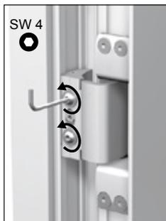
1. Befestigungsschrauben lösen.
