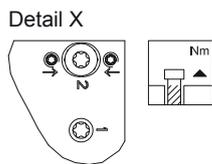
1. Befestigungsschrauben an allen Rahmenteilnahmen Pos. 1 max. ½ Umdrehung lösen
