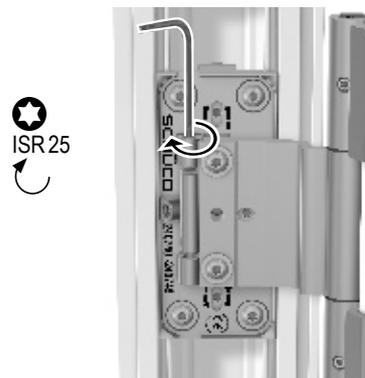
Dichtungsdruckverstellung (oben / unten)
